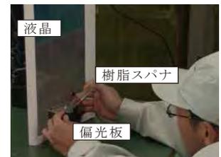
図3. 光弾性を利用した応力可視化装置
