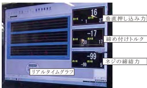
図2. ドライバー測定装置出力ディスプレイ
