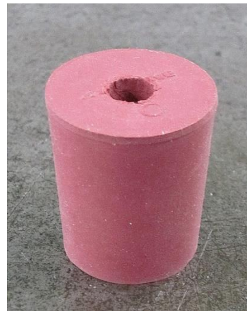
図 4-2 穴加工したゴム栓
