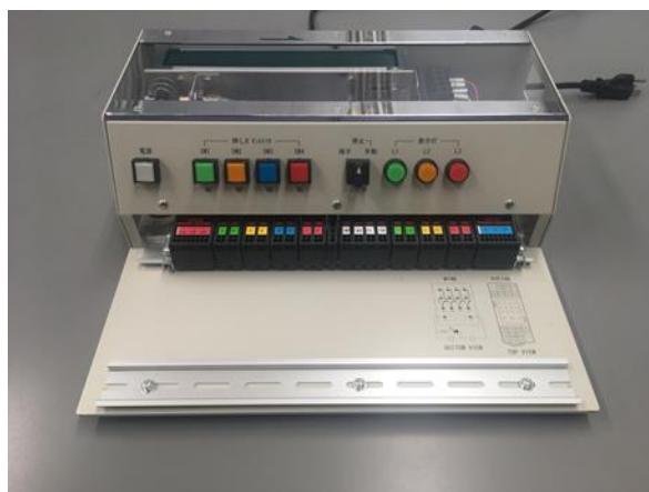
写真 2 PLC（シーケンサ）
