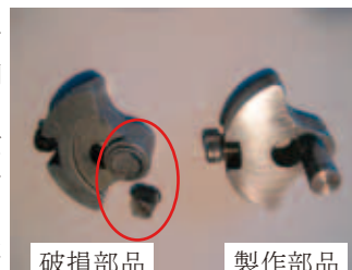
図4 破損部品及びその改善
