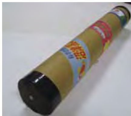
図1 製作した簡易分光器
