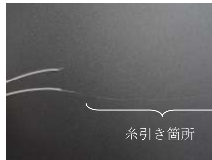
図3 吸湿した ABS 樹脂材料
