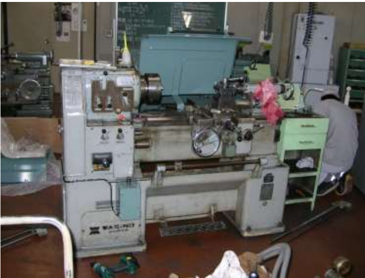
図1. レトロフィット中の 1972 年製の旋盤（アマダワシノ LR-55）
