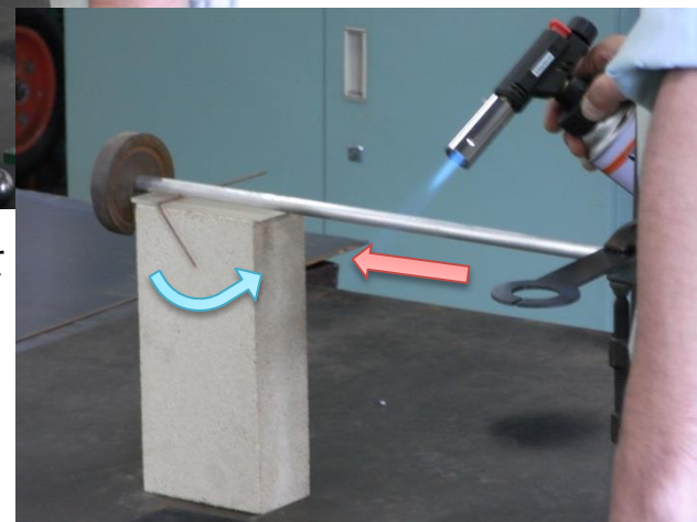
バーナーでアルミパイプを温めて 先端の針金が回る実験
