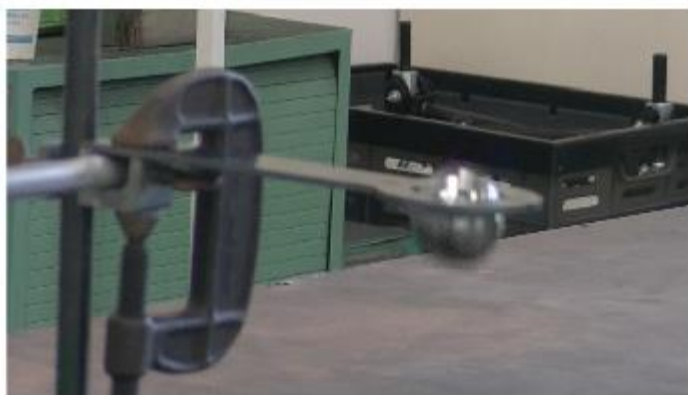
バーナーで鉄の輪っかを温めて 通らなかった鉄球が通る実験
