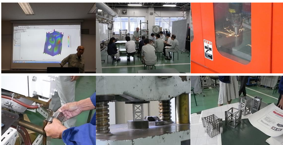
上段左から：CAE、加工説明、レーザ加工、下段：スポット溶接、圧縮試験、各試験後
