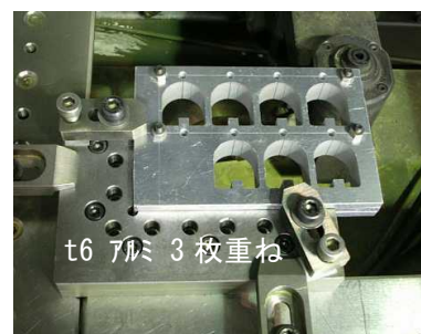
図5 量産部品加工例
