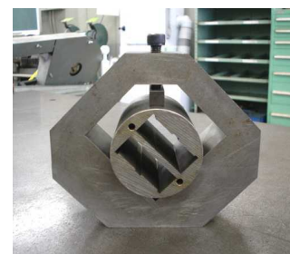
図3 おむすび形丸棒取付具
