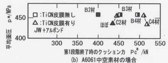
図5 ダイ表面処理(TiCN)の影響(第3段階までの加工)
