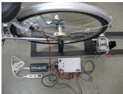
図 5 自転車発電システム 1
