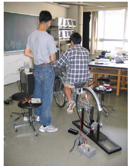
図 17 自転車発電システム 4
